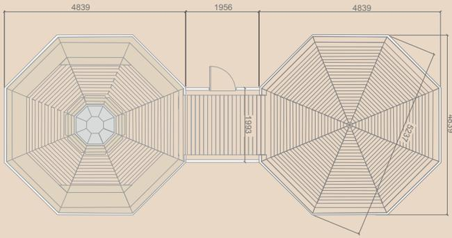
Abmessung der Verbindung: 1,95 x 1,99 m
